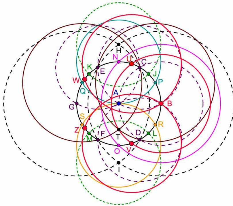
Figura 3: Costruzione del pentagono regolare UBZVW con il solo compasso.
